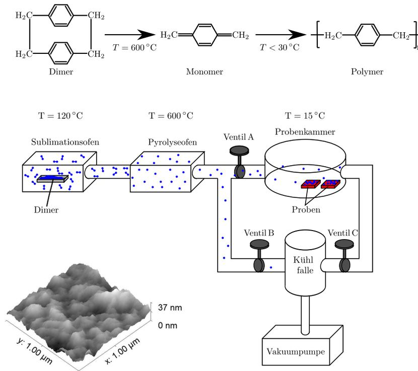
Abscheidungsreaktion von Parylen, bestehende CVD-Anlage und Höhenprofil einer Parylenschicht, aufgenommen mit einem AFM.
