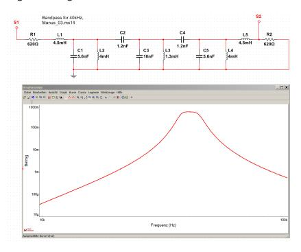
Bereits realisierter Bandpass um das Signal bei ca. 40 kHz heraus zu filtern. Design: S. Manus.
